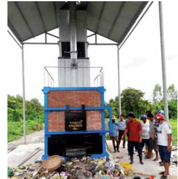
Thử nghiệm lò đốt rác thải bằng khí tự nhiên tại Bạc Liêu.
