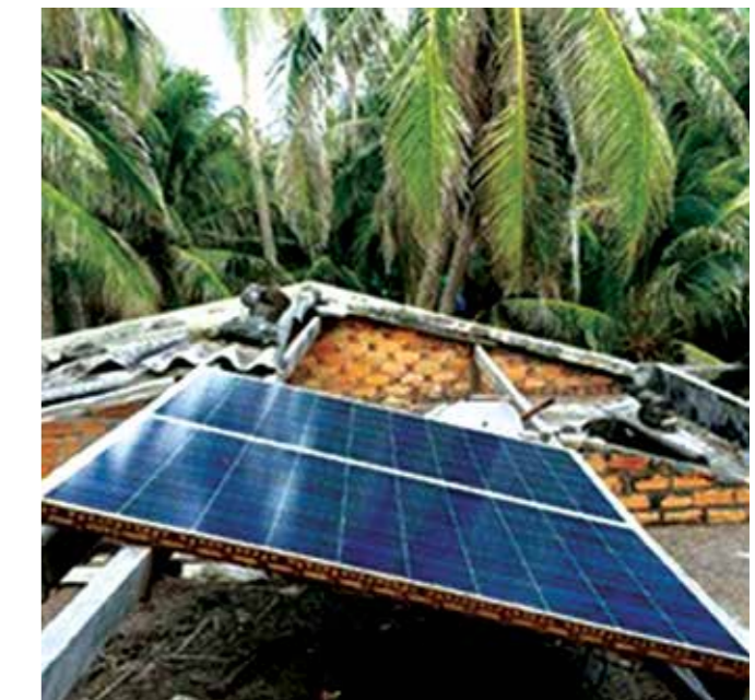
Hình 7: Hệ pin thử nghiệm sau 02 năm (ngày 23/6/2019) vẫn đảm bảo độ bền và công suất rất tốt.
