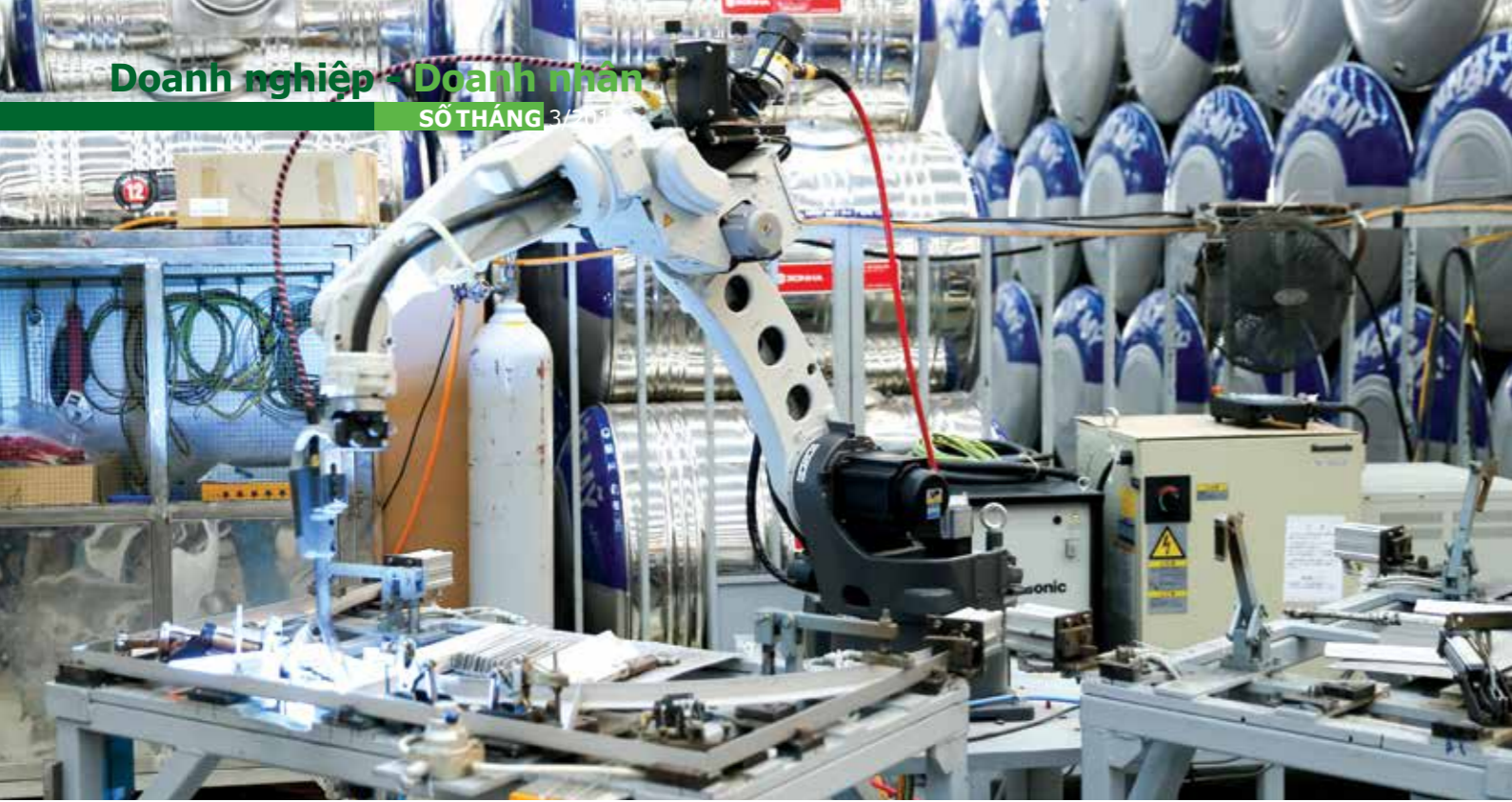
Sơn Hà sử dụng robot trong sản xuất nhằm tăng năng suất, hạ giá thành sản phẩm
