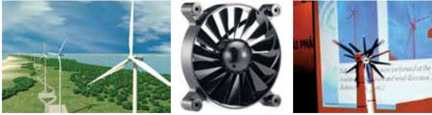
Tuabin gió trục ngang ít cánh, nhiều cánh, nhiều lớp cánh
